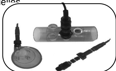
Figure 12. Montage des portes-sondes et de la sonde redox
