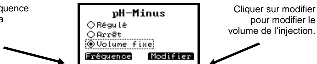
Figure 41. Réglage du volume et de la fréquence d'injection
