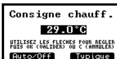
Figure 50. Écran de réglage de la température de l'eau
