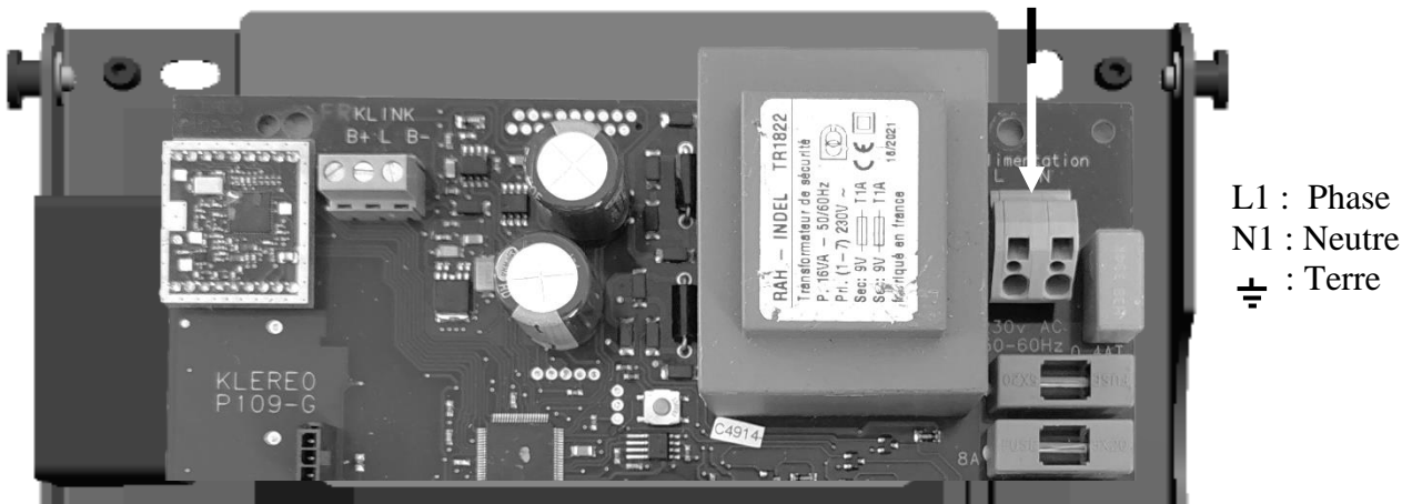
Figure 23. Branchement de l'alimentation de la centrale Kompact mini M9
